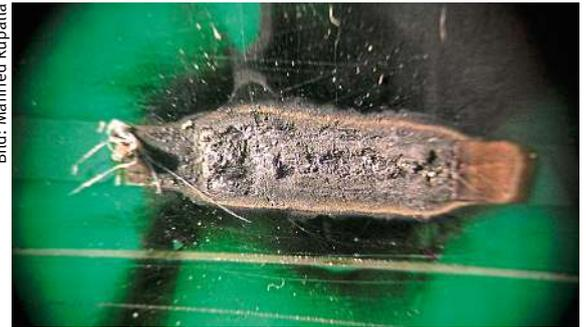
**Bild 3:** Verkokelte Leiterplatte nach dem Abschmelzen der Leiterbahnsicherung.
